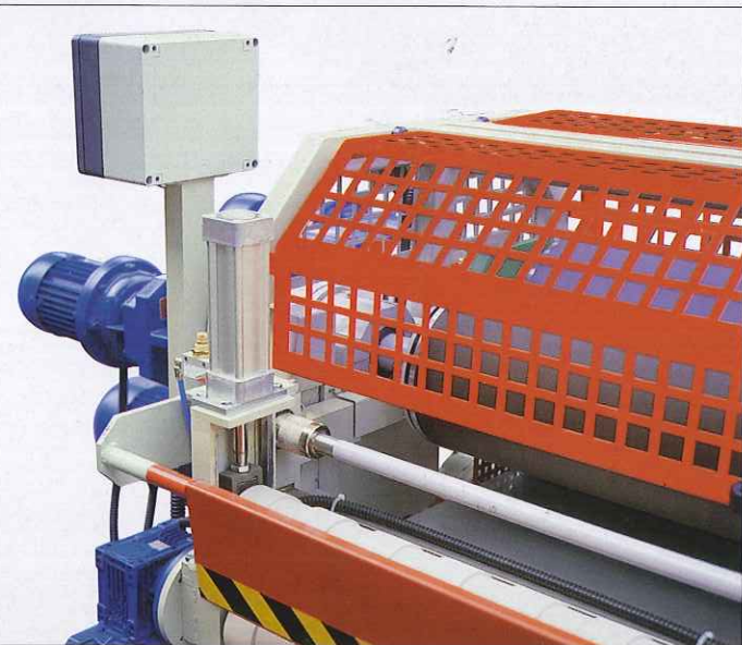
Vista di fronte introduttore automatico pneumatico per compensati. View of pneumatic automatic chipboard infeed front. Vue de face l'alimentateur pneumatique automatique des contreplaqués. Frontalansicht mit automatischem Pneumatikzuführer für Sperrholz.
