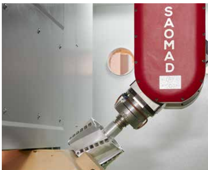
Lavorazione interpolata con utensile pialla. Interpolated working with planer tool.
