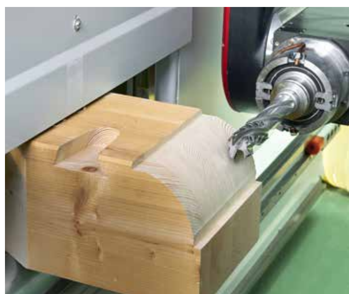
Lavorazione con interpolazione. Working with interpolation.
