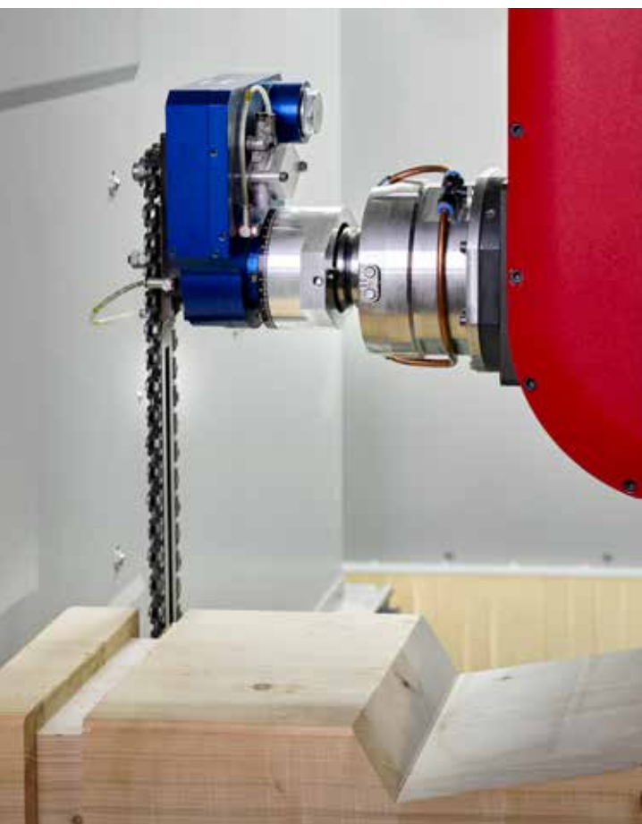
Lavorazione con aggregato Motosega. Working with chainsaw aggregate.
