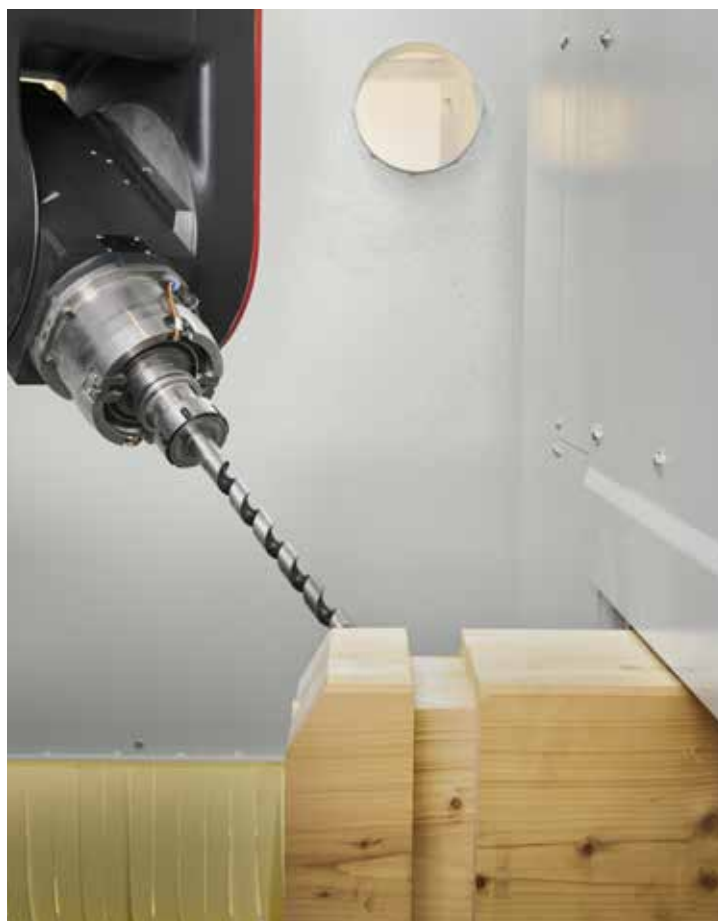
Possibilità di lavorazione punte con diverse angolazioni. Possibility of machining bits with different angles.
