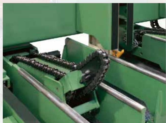
**КАНТОВАТЕЛЬ БРЕВЕН** с двойным шарниром, состоящий из двух независимых рычагов с гидравлическим подъемом. Оснащен тремя цепями с приводом от двигателя, с вращением по часовой стрелке и против часовой стрелки и с наклоном до 90°. Отлично подходит для любых типов бревен и для кантования обрезных досок без повреждения углов.
