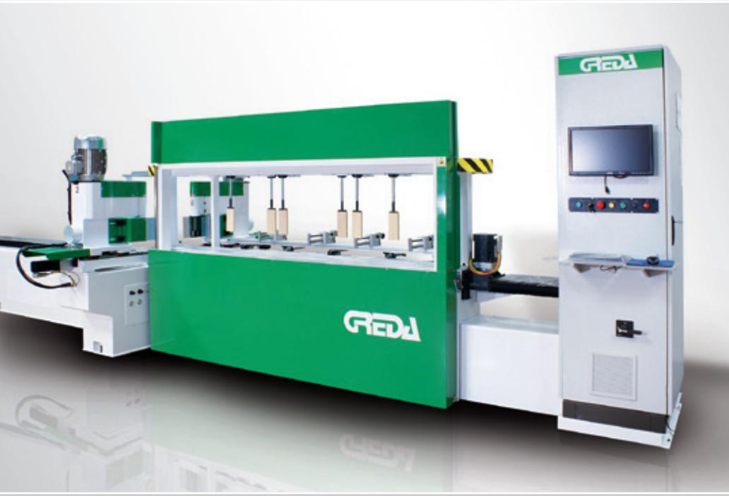
► CFL/CNC è una serie di macchine a controllo numerico ideata per eseguire lavorazioni di contornatura, fresatura e levigatura su elementi di sedie e pezzi in legno massiccio di forma allungata. Il percorso di fresatura è ottenuto tramite un controllo numerico che interpola la posizione del carro con la posizione di ognuna delle unità operatrici in funzione.
