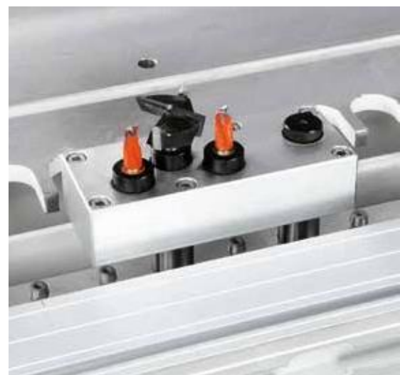
Группы для сверления под петли Для большой универсальности станка возможно оснащать его шпинделями с различными типами опциональных головок, способных выполнять отверстия под петли.
